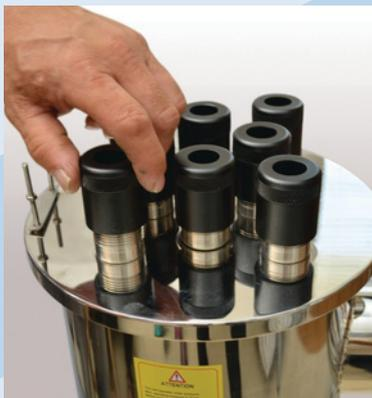
Setzen Sie die Hülsenkappe auf und drehen Sie sie im Uhrzeigersinn. Bevor Sie die Kappe vollständig festziehen, stecken Sie Ihren Finger in die Kappe und ziehen Sie die Quarzhülse vorsichtig nach oben, bis sie in ihrem Schlitz in der Hülsenkappe anliegt. Ziehen Sie die Kappe anschließend so fest wie möglich von Hand fest. Verwenden Sie hierfür kein Werkzeug. Wiederholen Sie den Vorgang für alle Hülsen
